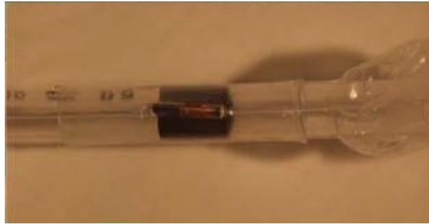
Figura 4 - Tag RFID collegato appena al di sopra del palloncino terminale del tubo endotracheale.
